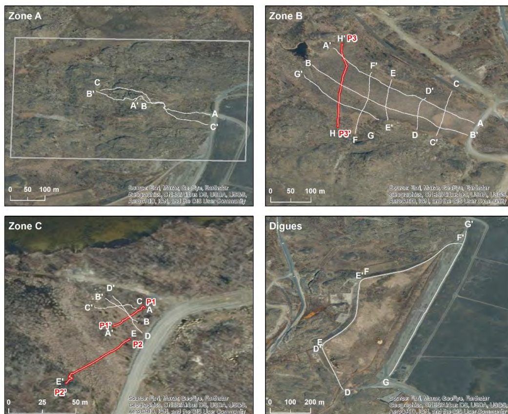
Figure 5.14 Profils de résistivité électrique (rouge) et profils GPR (blanc) dans les zones B et C
