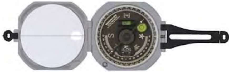
Figure 4.2 Boussole marque BRUNTON Com-Pro Pocket Type Transit
