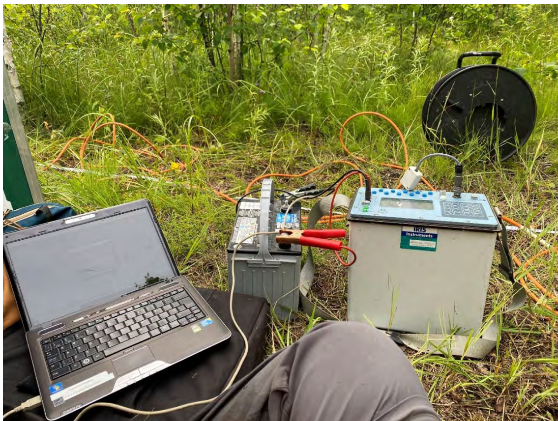
Figure 4.5 Résistivimètre SYSCAL Pro SWITCH 72 d' IRIS Instruments du GRES
