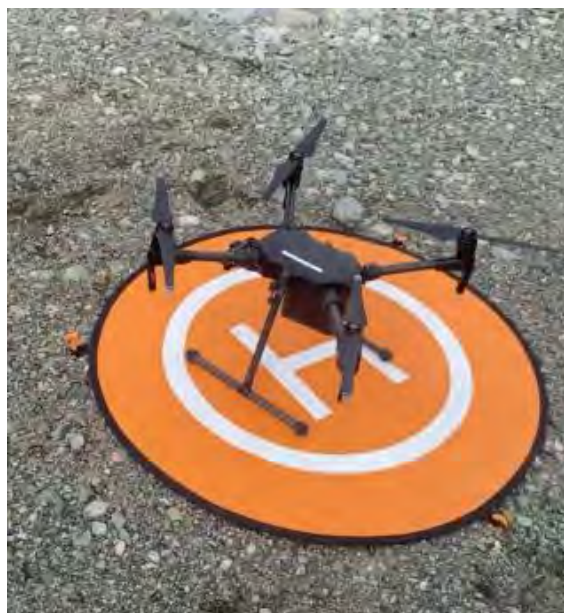
Figure 4.4 Drone DJI Matrice 200 avec caméra Zenmuse XT2 du GRES
