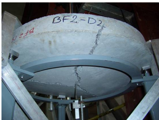
Figure 3.14 Photos de l'essai de flexion sur dalle
