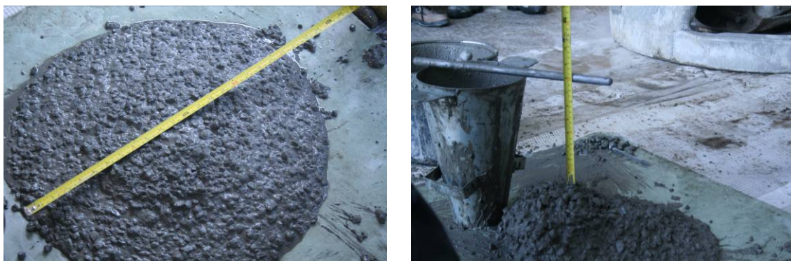
Figure 3.8 Essai au cône d'Abrams avant (à gauche) et après (à droite) l'insertion des fibres
