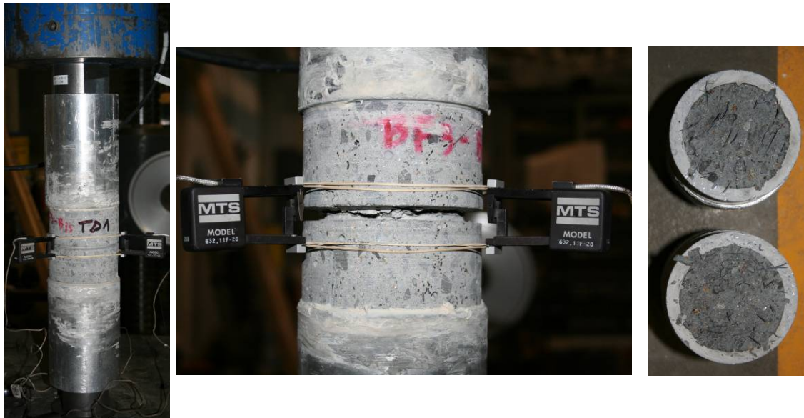
Figure 3.12 Photos de l'essai de traction uniaxiale
