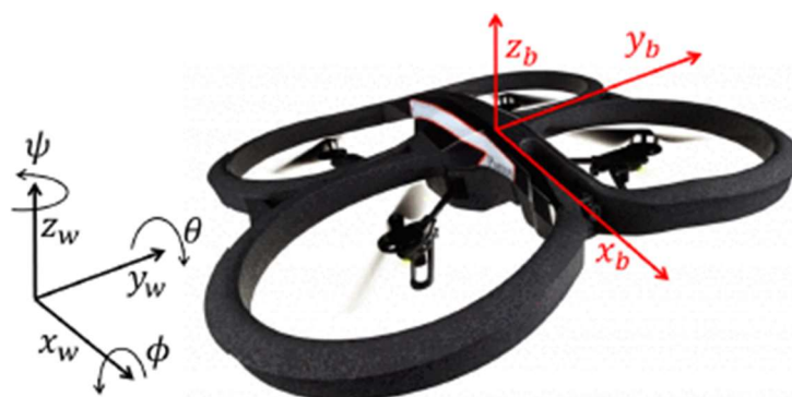
Fig. 2.1. : Quadrirotor AR.Drone 2.0 avec ses systèmes de coordonnées (© 2014 IEEE [7])
