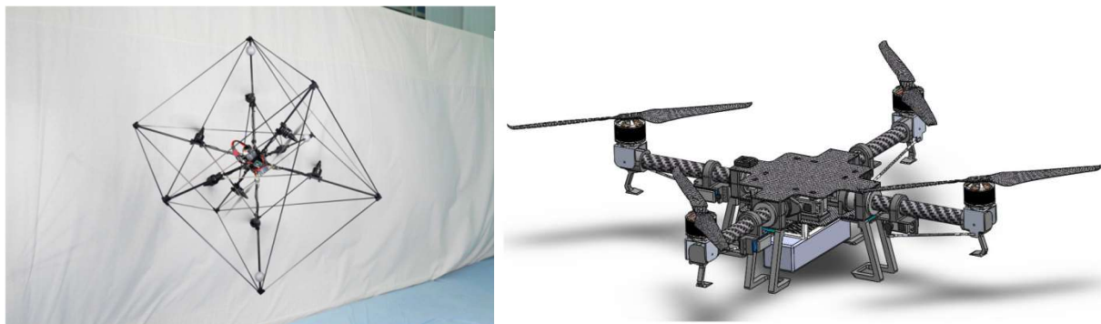
Fig. 2.6. : Drone omnidirectionnel sans rotors inclinables à gauche (© 2016 IEEE [31]) et quadrirotor avec rotors inclinables sur deux axes à droite [32]
