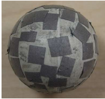
Figure 5.8 Balle de ping-pong utilisée pour les tests expérimentaux. Des morceaux carrés de ruban réfléchissant sont placés sur la balle pour la capter par le système de capture de mouvements.
