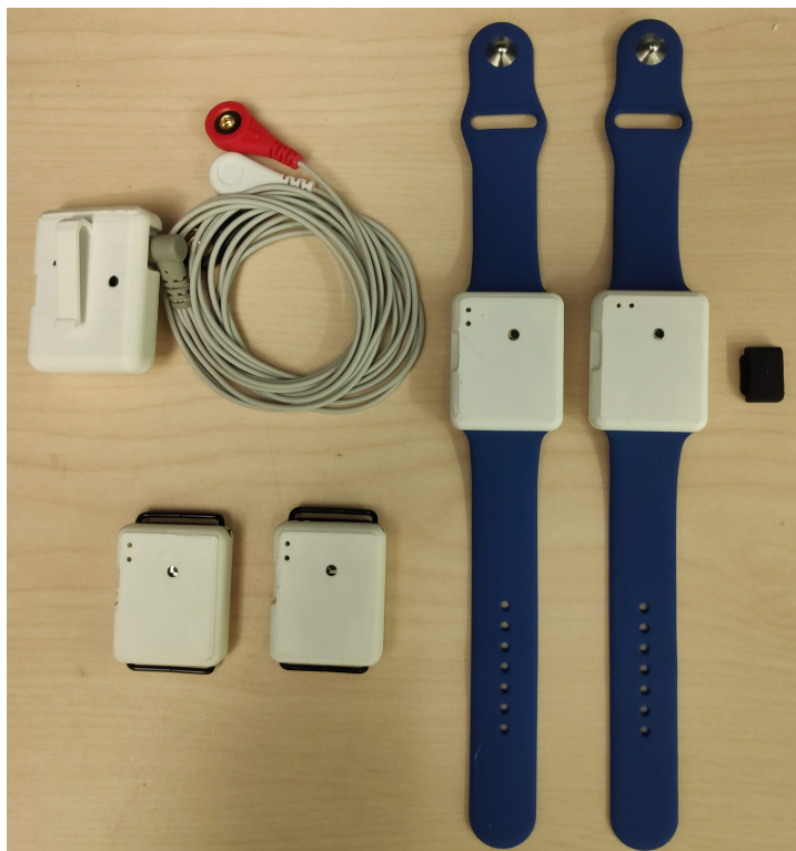
Figure 5.1 Système complet après assemblage. Impression du système mécanique par impression 3D avec du filament PLA.
