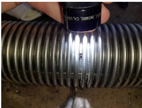
Figure ANNEXE 7.1 Exemple de trous apparaissant sur la conduite du syngaz après le cyclone
