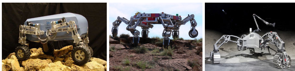
Figure 1.3 Exemples de rovers articulés. De gauche à droite : HYLOS, ATHLETE et SHERPA.
