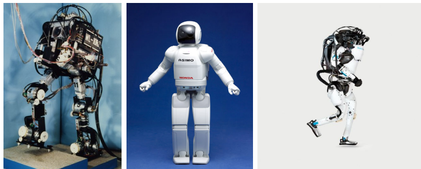
Figure 1.1 Exemples de robots bipèdes. De gauche à droite : WL-10 RD, ASIMO et ATLAS.
