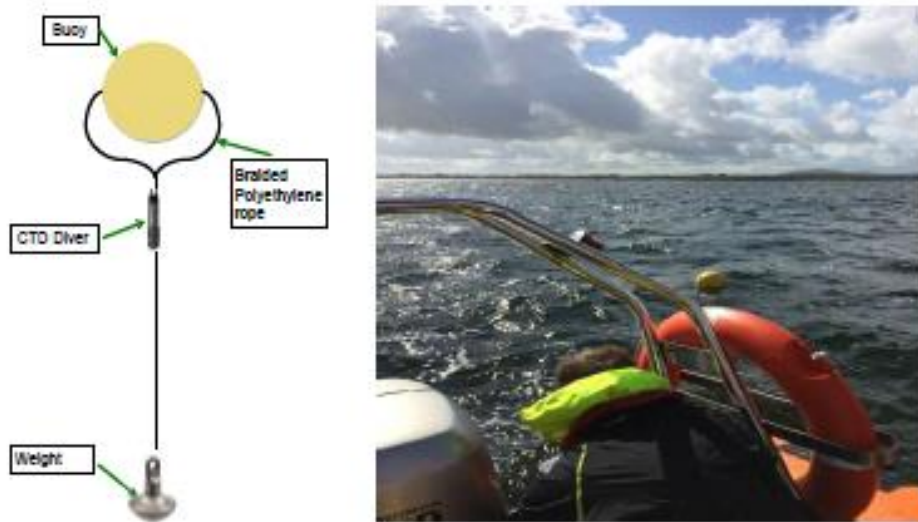
Figure 2.25: Montage d'une sonde thermique pour la collecte des mesures in situ ( McCaul et al., 2016 )
