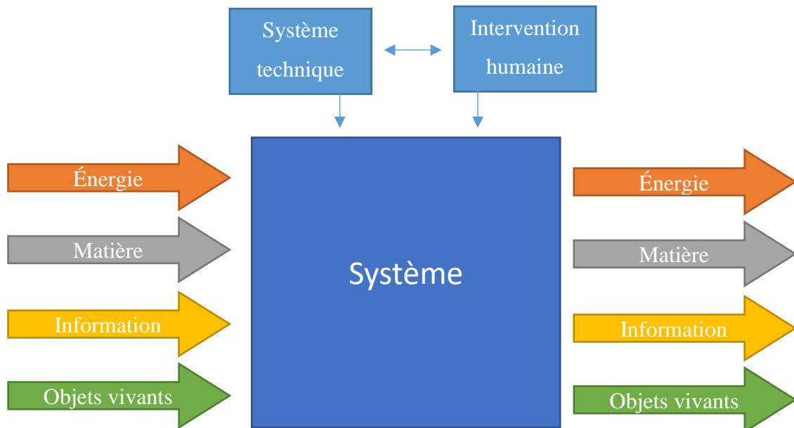
Figure 2.1 Décomposition des flux d'un produit (Hubka, 1988)
