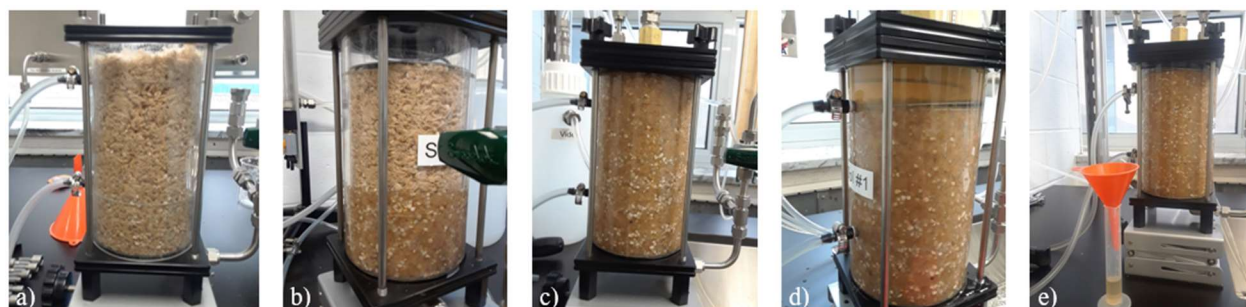
Figure 3.1 Montage de l'essai de perméabilité avec la FLP.
