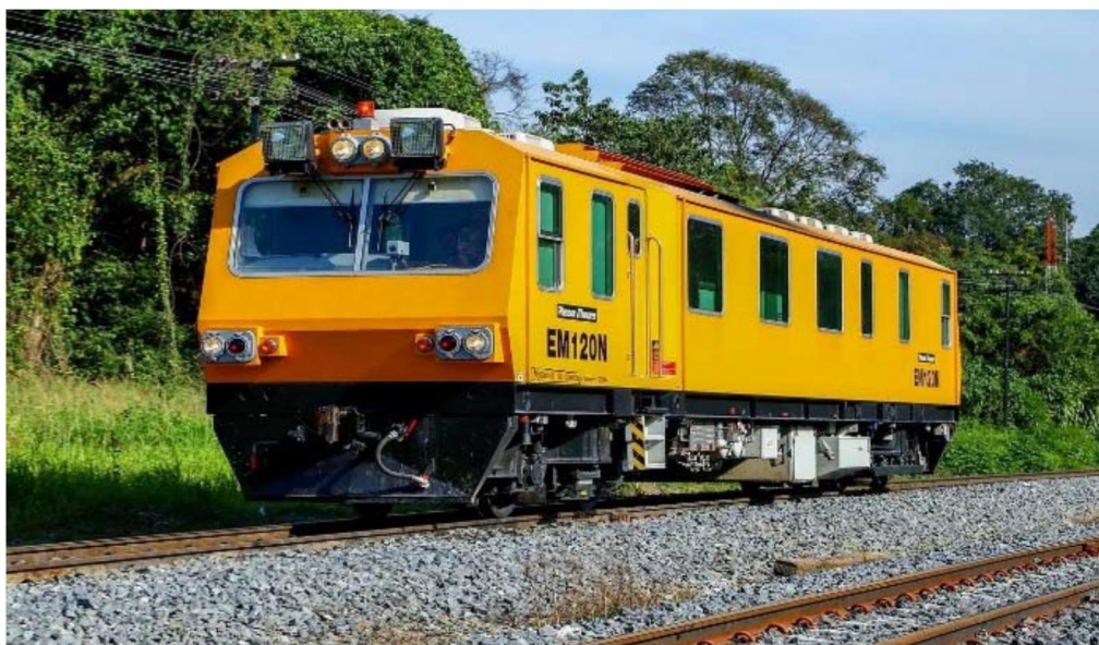
Figure 3-3 : Train d'évaluation de la géométrie de la voie ferrée EM120N (State Railway of Thailand, 2015, cité dans Phanyakit et Satiennam, 2015)
