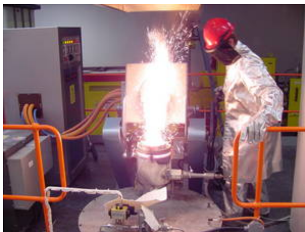
Figure 4.1 Atomiseur utilisé pour produire les poudres d'alliage mère. Sur cette photo, le métal liquide est coulé dans le panier répartiteur. Le système de distribution d'argon n'est pas représenté sur cette photo. [12]
