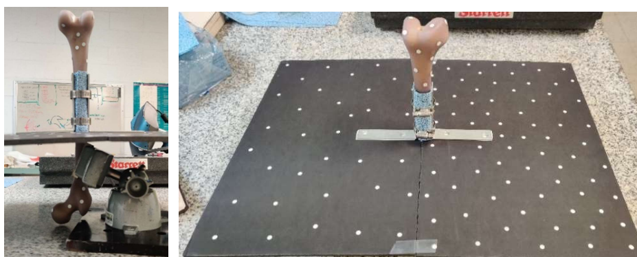
Figure 4-36 Seconde configuration de l'os artificiel pour une digitalisation avec un scanner 3D. A gauche une vue de côté et à droite une vue du dessus.
