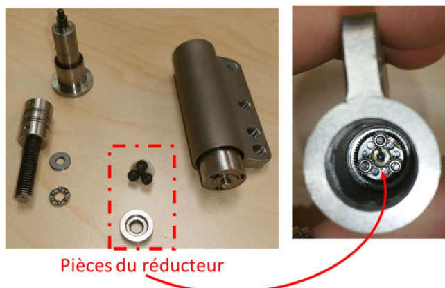
Figure 4-16 Ouverture de D2. Zoom sur le réducteur brisé vue à l'entrée du canon du côté du bouchon enlevé préalablement.
