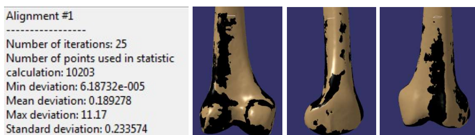
Figure 4-40 Recalage sélectionné entre les nuages de points du fémur incomplet et des condyles fémoraux. Gauche : les statistiques du recalage. Droite : superposition du nuage de points du fémur incomplet et de celui des condyles fémoraux recalés en noir.
