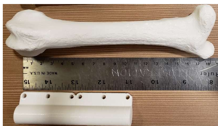
Figure 4-4 Comparaison de longueur entre des impressions 3D du fémur d'un mouton de 2ans et la version E-Kut du dispositif à l'étude
