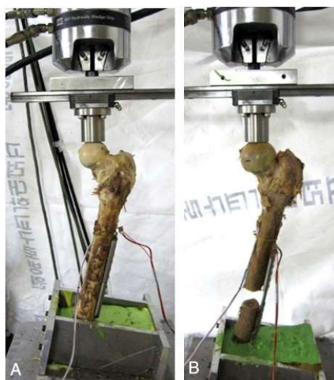
Figure 2-22 Essai in vitro du fémur fixé au système de plaque d'allongement de l'os (BLP). (A) Groupe témoin : fémurs ostéotomisés fixés au système BLP avec une longueur d'allongement de 0 mm, (B) Groupe expérimental : fémurs ostéotomisés fixés au système BLP avec une longueur d'allongement de 30 mm. "Biomechanical assessment of a novel bone lengthening plate system — A cadaveric study" par T. G. Jung, S. W. Suh, S. J. Lee, B. Kim, D.-W. Han et J. H. Yang, 2013, Clinical Biomechanics , 28(2), Volume 28, p. 232-238. © 2013 par Jung et al. Reproduit avec permission (Jung, T. G. et al., 2013).
