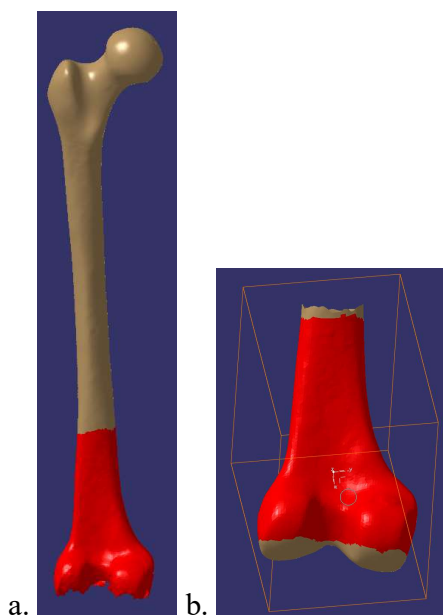
Figure 4-39 Zones de sélection de l'outil align by best fit sur les nuages de points du a. fémur incomplet et b. des condyles fémoraux.
