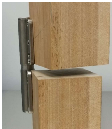
Figure 4-24 D4 brisé après un test de distraction à 22,6kg.
