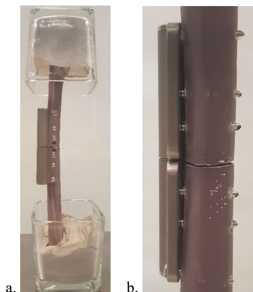
Figure 4-11 D2 sur son support pour le test de distraction, a. vue globale en plan frontal, b. zoom sur les vis de verrouillage en plan sagittal.
