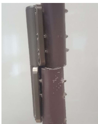
Figure 4-15 D2 brisé après un test de distraction à 20kg.
