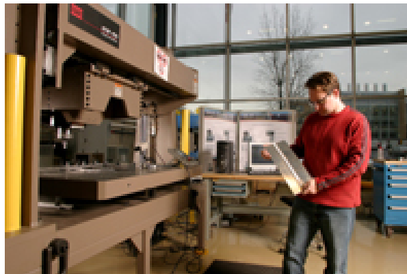
Figure 2-2: Machine de soudage par frottement-malaxage MTS I-stir du CTFA.
