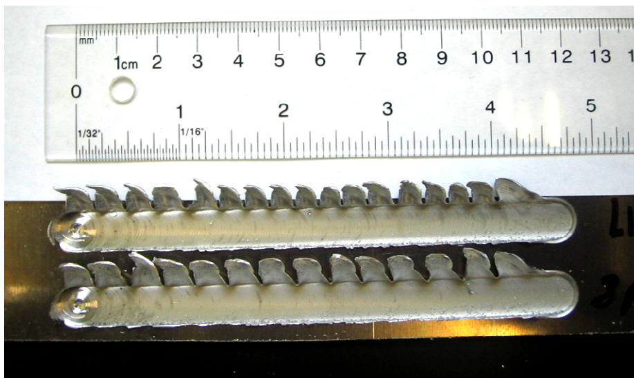
Figure 2-4: Bavures latérales excessives obtenues en utilisant une force verticale trop grande
