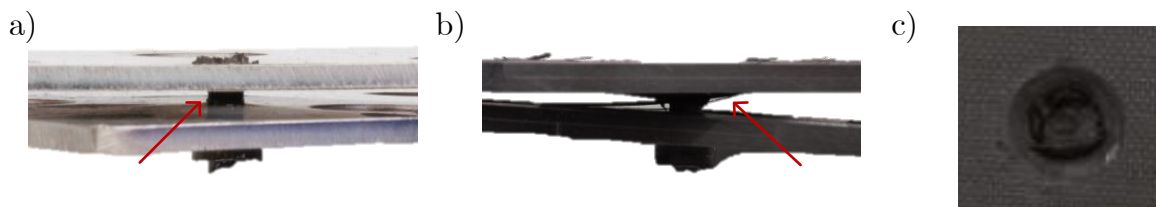
Figure 5.9 Photos des rivets en CF/PEEK testés en tension. a) Endommagement dans le corps d'un rivet dans des plaques d'acier. b) Présence de zones délaminées autour du rivet dans les plaques en CFRP. c) Arrachement de la tête chanfreinée à travers le trou dans une plaque en CFRP.
