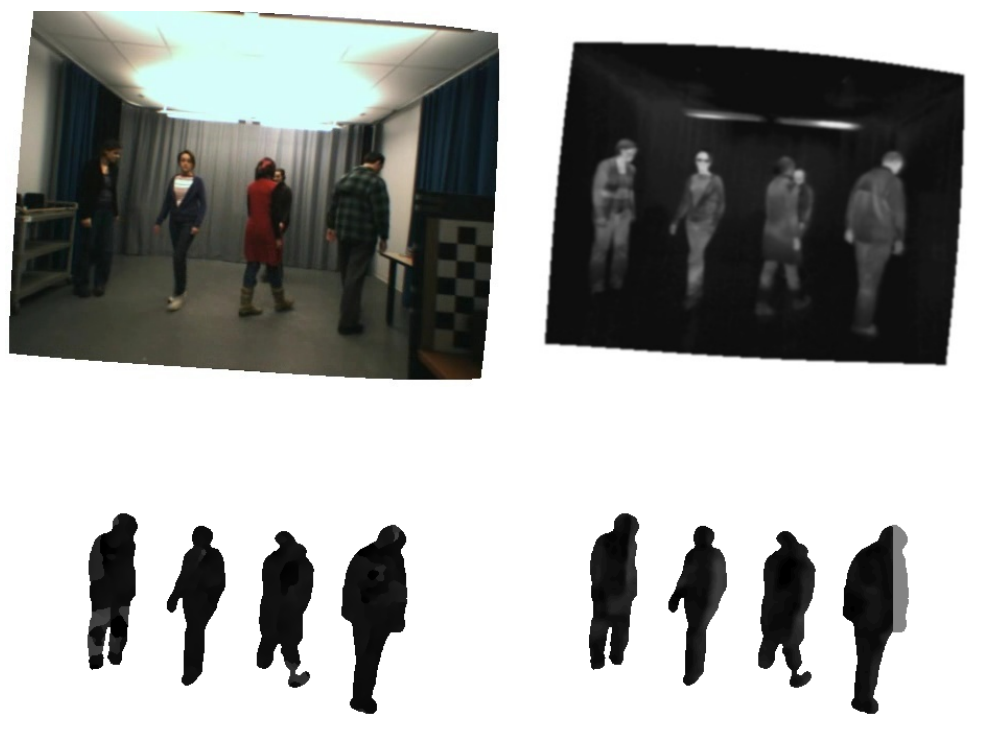
Figure 6.4 Images RGB et LWIR (première rangée) avec les cartes de disparités segmentées de l'article un et deux (deuxième rangée). Les pixels foncés correspondent à des plus petites disparités. Remarquons qu'un sujet est presque complètement caché par un autre, ce qui n'est pas réflété dans aucune des cartes de disparités. Il est conseillé de zoomer sur les résultats pour bien voir les valeurs de disparités.
