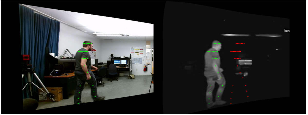
Figure 1.1 Illustration de la disparité en stéréoscopie : en vert, les points correspondants et en rouge, les points de l'image de gauche projetés dans l'image de droite. La disparité correspond à la distance entre les points verts et rouges dans l'image de droite.
