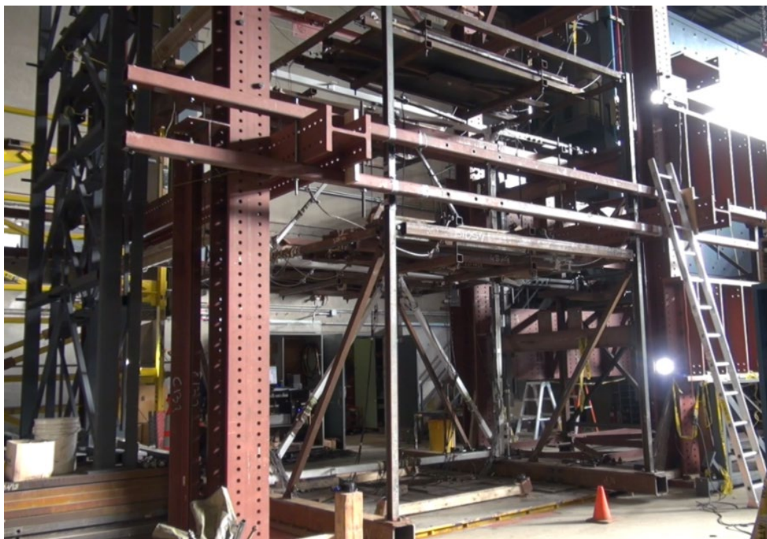
Figure 1.6 Montage expérimental réalisé ; configuration avec les masses annexes connectées (configuration Montréal) : a) Illustration schématique ; b) Photographie
