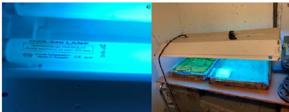
Figure 3.7: Exposition des PSAs aux rayons UV : a) lampe UVA-340 utilisée pour les essais de rayonnement. b) Exposition des échantillons aux rayons UV: h = 28 \text{ cm} ; T = 26,8 \text{ }^{\circ}\text{C} , \lambda = 340 \text{ nm} .
