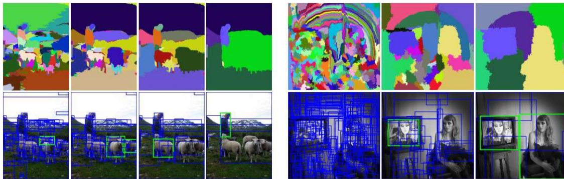
FIGURE 2.1 Exemples du fonctionnement de Selective Search avec des boîtes de différentes échelles [4] © 2014 IEEE.
