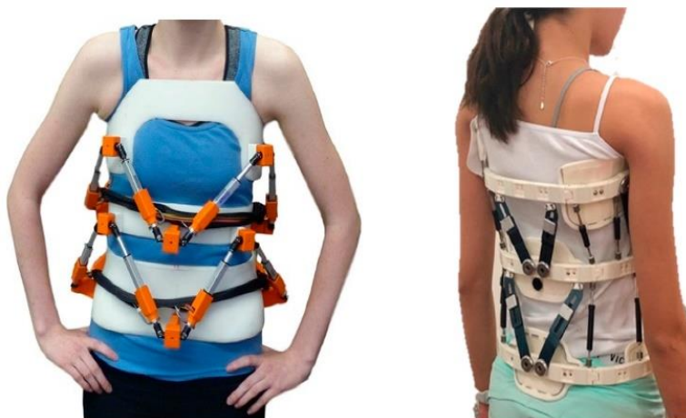
Figure 2.18 Exemples de corsets actifs par plateformes de Stewart-Gough. Extrait de (Ali et al., 2021) (images utilisables sous licence CC BY 4.0).
