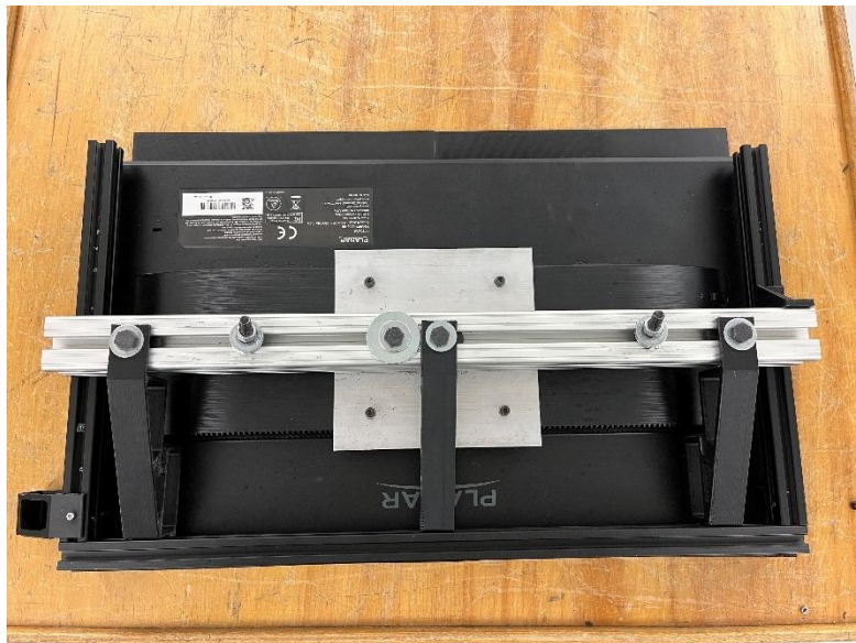
Figure 3-7: Système de rails (noirs, sur le contour de l'écran) permettant de fixer des boutons physiques à l'écran
