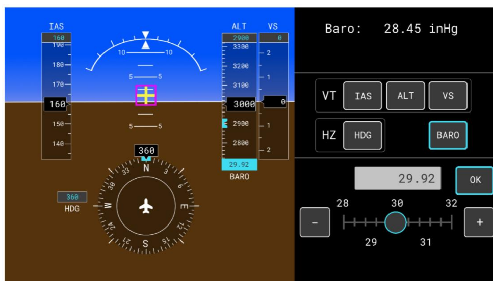
Figure 3-11: Interface graphique du dispositif tactile basé sur le bouton-glissoir.
