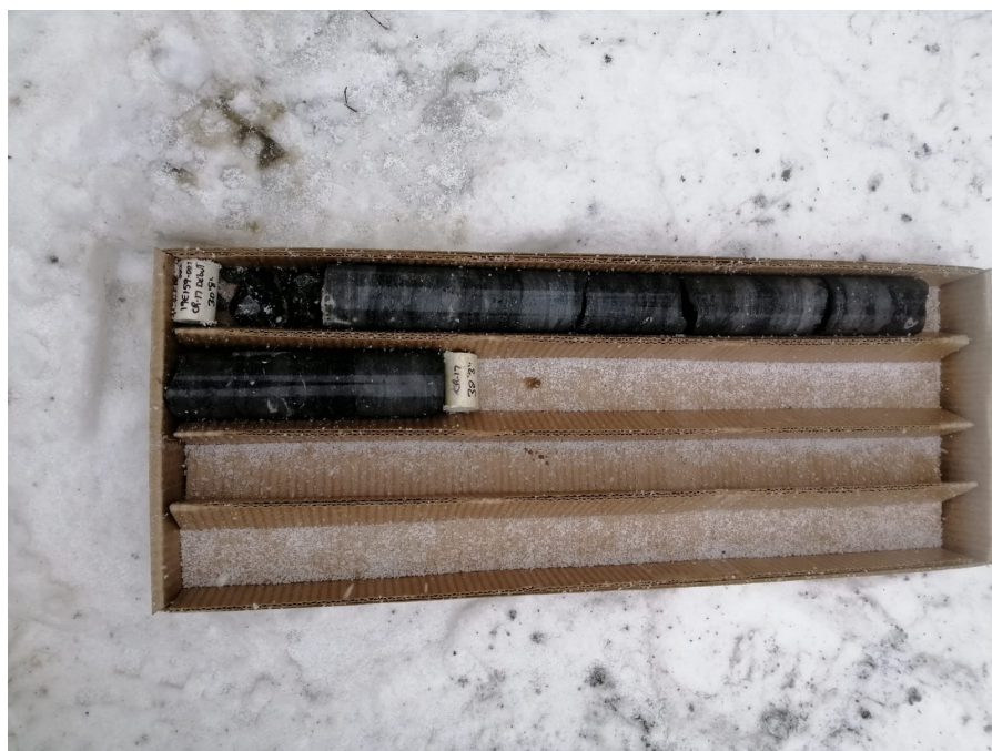
FIGURE 3.4 Carottes prélevées du forage d'exploration réalisé sur le site d'étude
