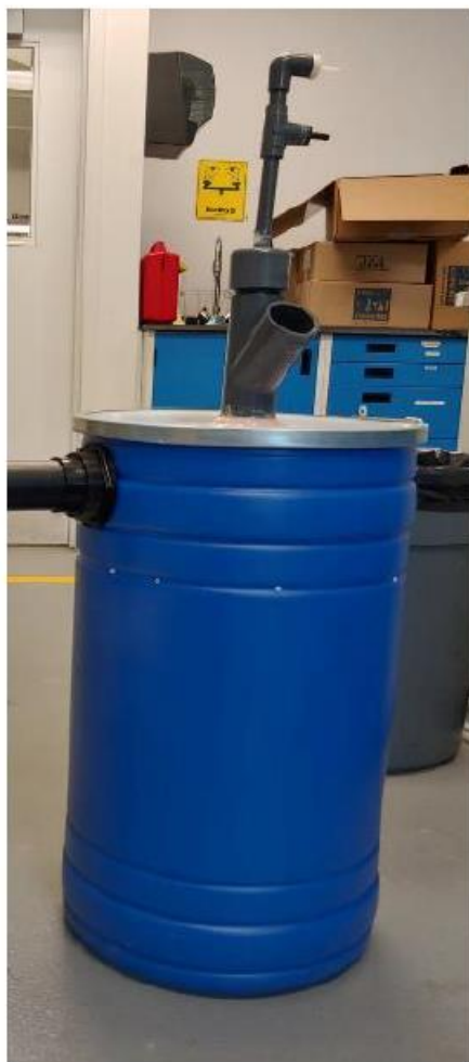
Figure A-1 Photo du réacteur UASB à la suite de sa construction (Boutin, 2020)
