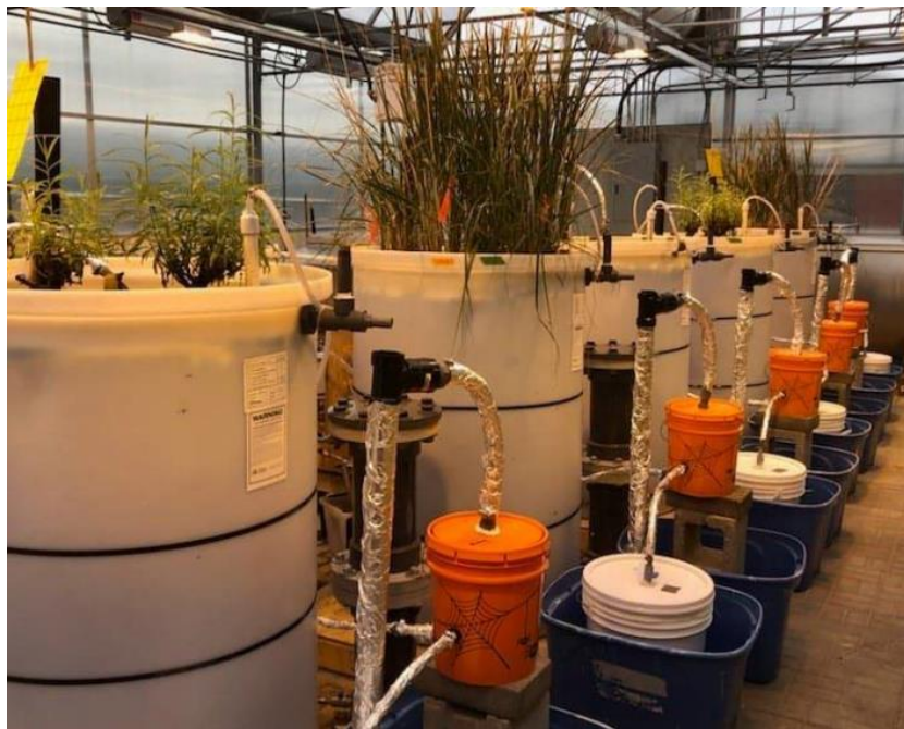
Figure 3-2 Disposition des FAV à l'échelle pilote au Phytozone (Boutin, 2021)
