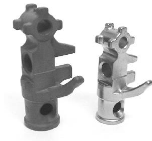
Figure 1.3 Pièce après déliantage (gauche) et après frittage (droite) (Dumas, 2008).
