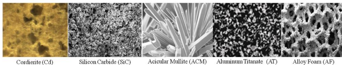
Figure 2.7 : Différents types de céramiques pour les FAP (Guan et al. 2015).
