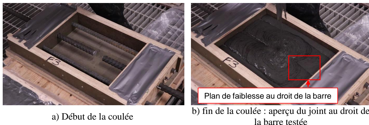
Figure 4.4 Coulée spécimen S1-F3 : vue du plan de faiblesse
