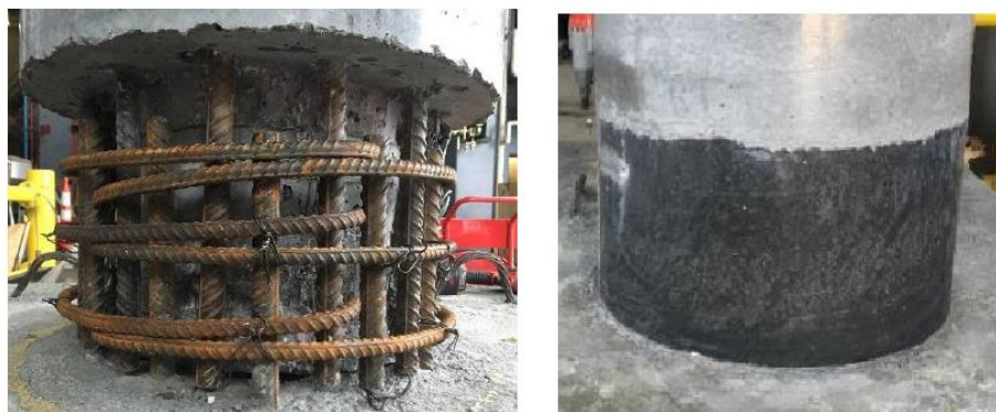
a) Joint avant et après application du BFUP
