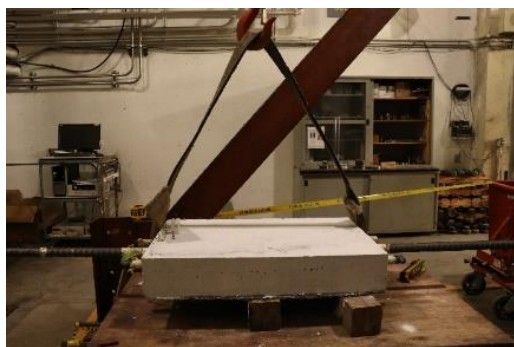
a) Mise en place spécimen sur la table forte
