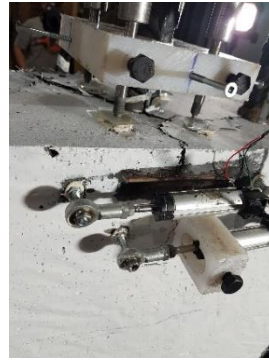
b) f_s = 320 \text{ MPa} : apparition fissure dans le plan
