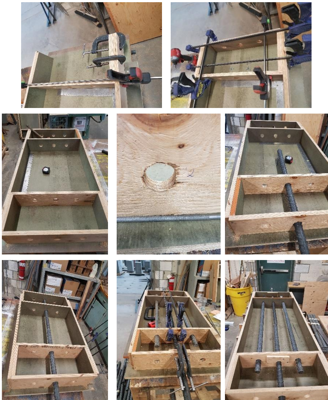
Figure 6.11 Fabrication coffrage spécimen
