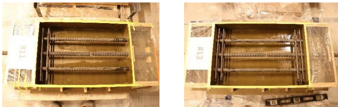
a) Sans armature transversale sur la barre testée b) Avec armature transversale sur la barre testée
