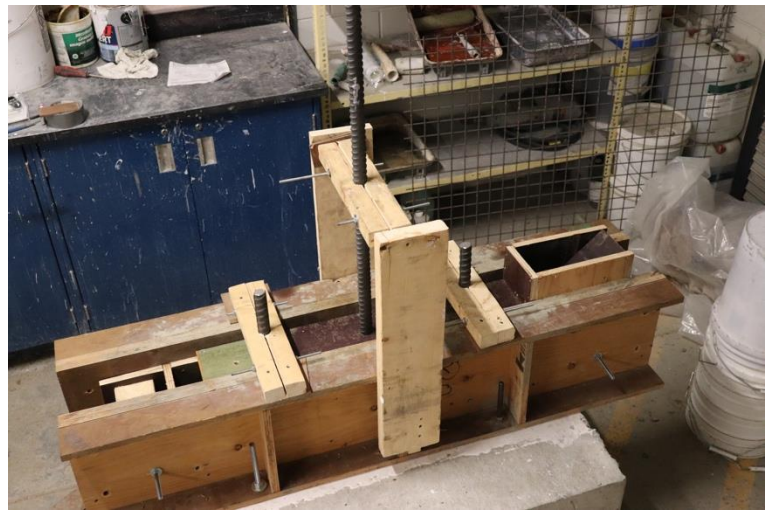
Figure 4.16 Coffrage du muret en BFUP
