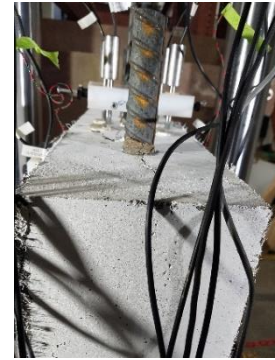
c) f_s = 280 \text{ MPa} fissure dans le plan
