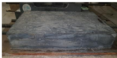
Figure 6.29 Vue plan de faiblesse spécimen
