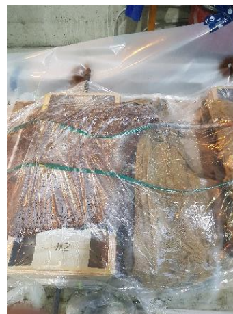
b) Jute sur spécimen pour la cure humide
