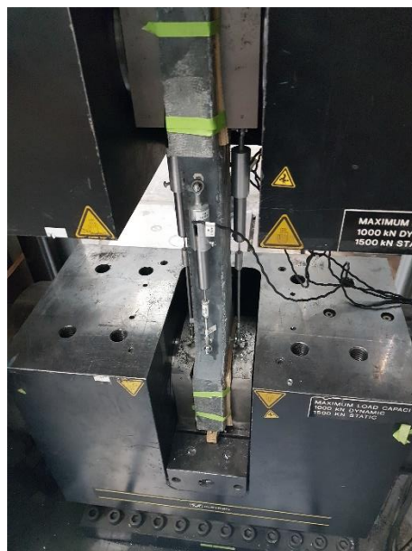
Figure 6.18 Montage expérimental d'un essai d'os dans la presse INSTRON
