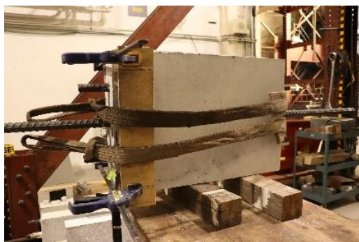
c) Mise en place élingues pour transport en panier
