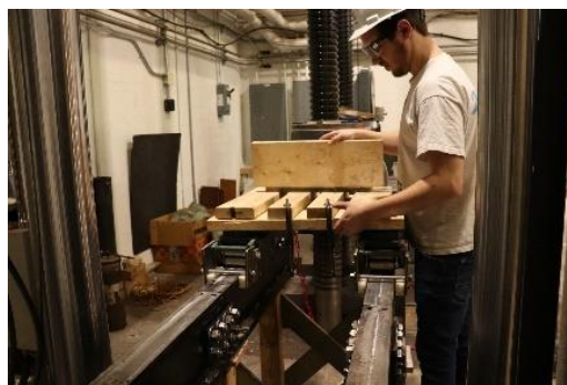
d) Mise en place rail et chariots
