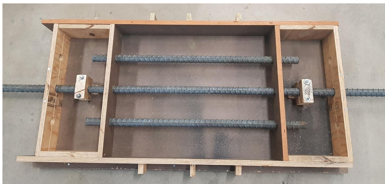
Figure 6.3 Coffrage DTP – Test préliminaire
