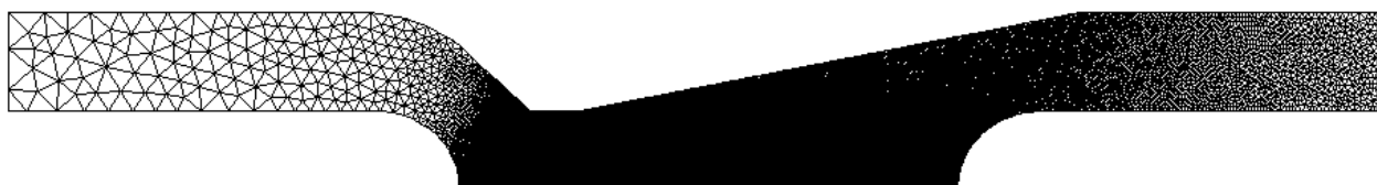
FIGURE I.1 Maillage de 93 905 nœuds et 186 307 triangles utilisé en MC3 pour la tuyère de Lewis
