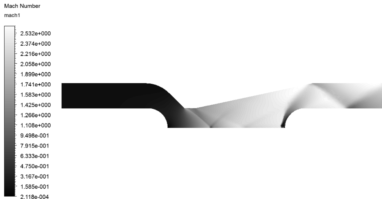
FIGURE 4.9 Courbes d'isosurfaces du nombre de Mach pour la tuyère de Lewis allongée sous CFX
