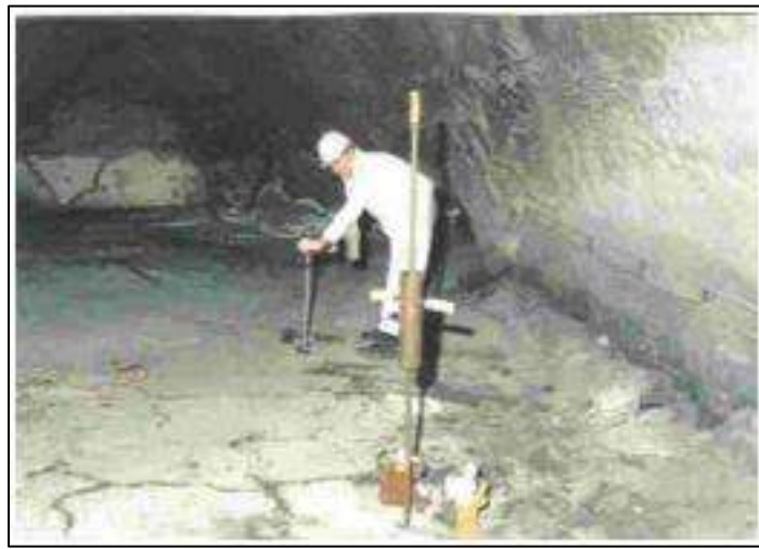
Figure 2.18: Mesure de la résistance au cisaillement d'un remblai hydraulique sur le chantier (tiré de Marx et al. 2005)
