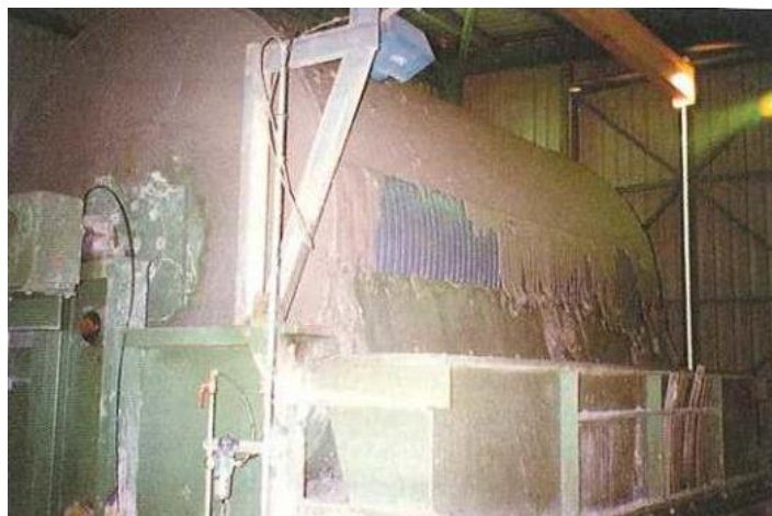
Figure 2.4 Un filtre à disque (tirée de Potvin et al., 2005)
