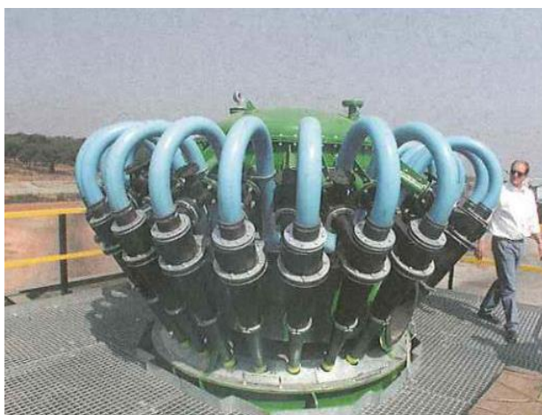
Figure 2.2 Série d'hydrocyclones (tirée de Potvin et al., 2005)
