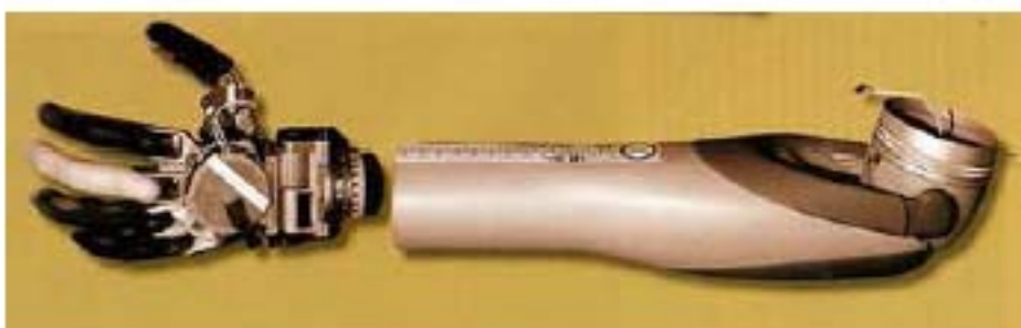
Figure 1.2 : Prothèse artificielle du membre supérieur disposant de sept degrés de liberté (Tenore et al., 2008).
