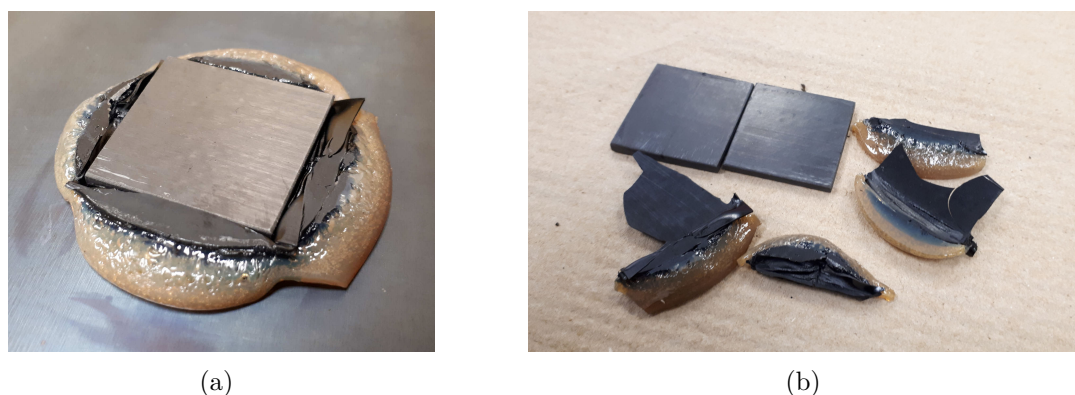
Figure 6.13 Essai de soudage à la presse à 280 °C pour l'élastomère PEI-siloxane présentant a) l'échantillon à la sortie de la presse et b) l'adhésion de l'élastomère sur le nanocomposite
