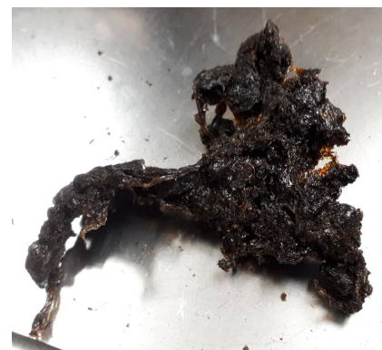
Figure 6.14 Évaluation de la stabilité thermique du PEI-siloxane à l'aide d'un mélangeur interne présentant a) l'évolution du couple pendant le mélange et b) l'état de dégradation de l'élastomère après 40 minutes
