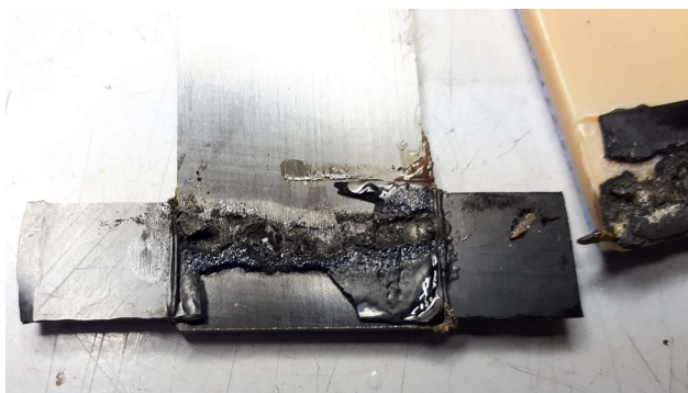
Figure 6.17 Faciès de rupture après un essai mécanique d'une soudure multimatériaux
