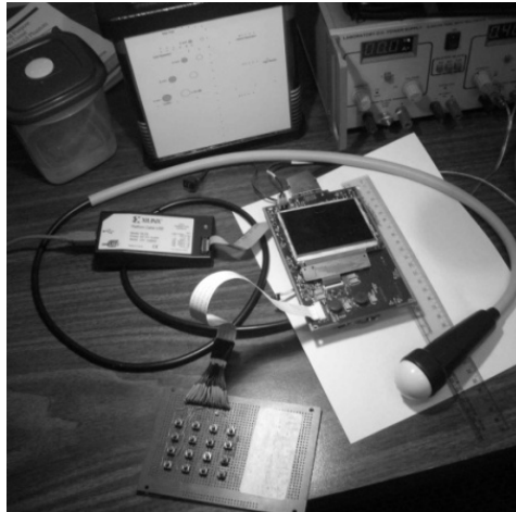
Figure 4.9 : Photographie du système échographique miniaturisé son ensemble montrant la sonde et le clavier matriciel 4x4
