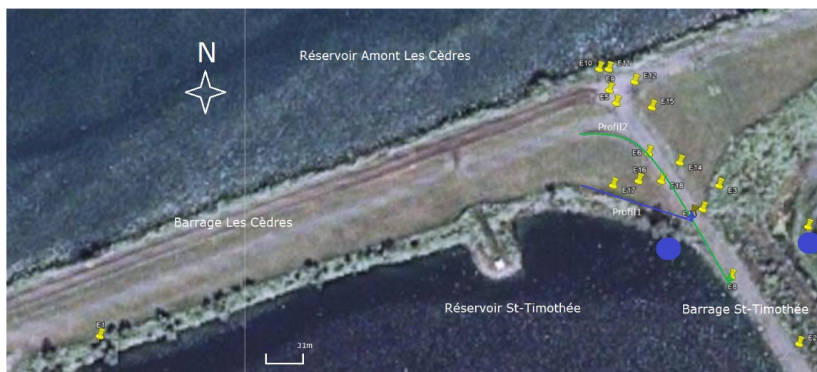
Figure 4.11: Localisation des mesures à la jonction des barrages avec la position des profils de résistivité (réalisés en 2008 et 2009; le profil 1 est en bleu et le profil 2 en vert), la localisation des électrodes (l'électrode E1 est la référence) et les infiltrations visibles pendant la vidange et la mise en eau du réservoir St-Timothée sont indiquées par des ellipses.
