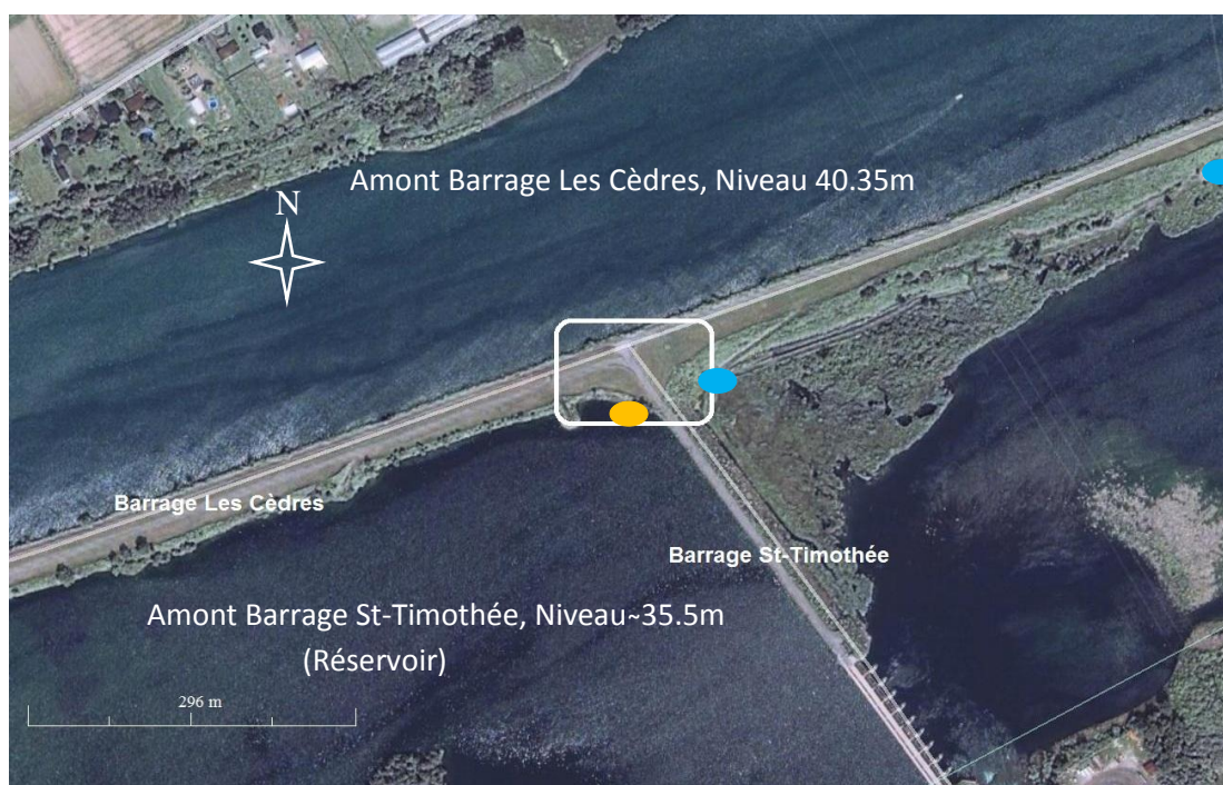
Figure 4.1: Vue en plan des barrages à leur jonction. Les sorties d'eau visibles sont représentées par les ellipses (orange et bleue). L'ellipse orange désigne la fuite visible lorsque le réservoir est vide.
