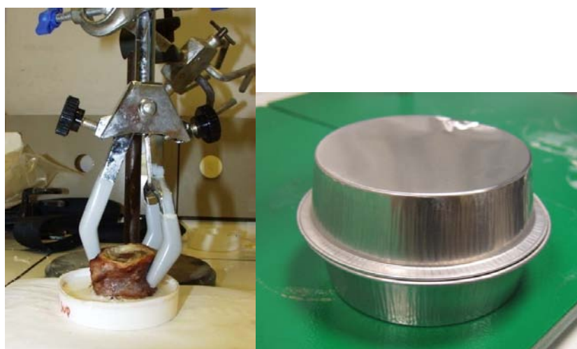
Figure 3.5 : Le dispositif de scellement des vertèbres
