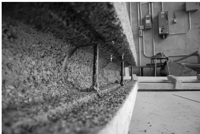
Figure 4-5 - Surface à granulats exposés de la niche
