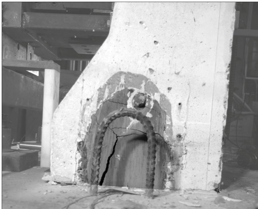
Figure 4-21 - Rupture du parapet BRF50MPa-1% avec surface de niche préparé au jet de sable.
