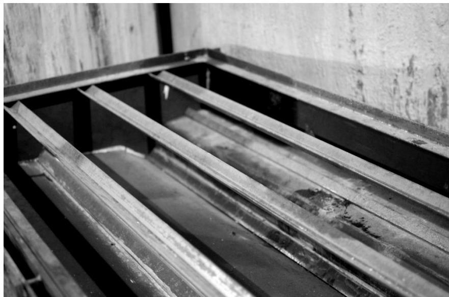
Figure 4-6 - Moule pour la fabrication du cœur en BO40MPa du parapet hybride
