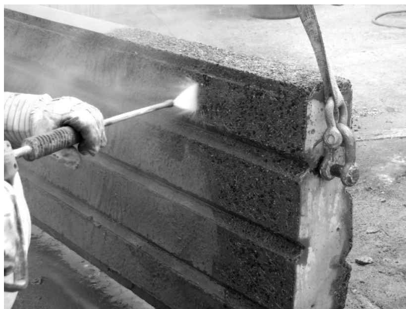
Figure 4-7 - Obtention d'une surface à granulats exposés, cœur de BO40MPa
