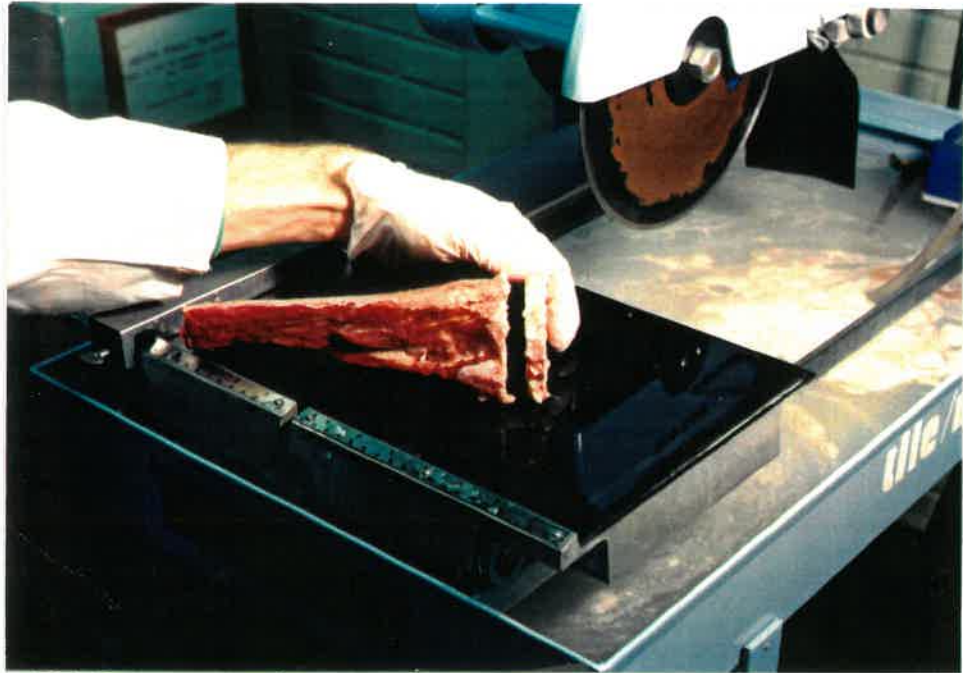
FIGURE 5.6 Section d'os trabéculaire utilisée pour fabriquer les cubes d'os
