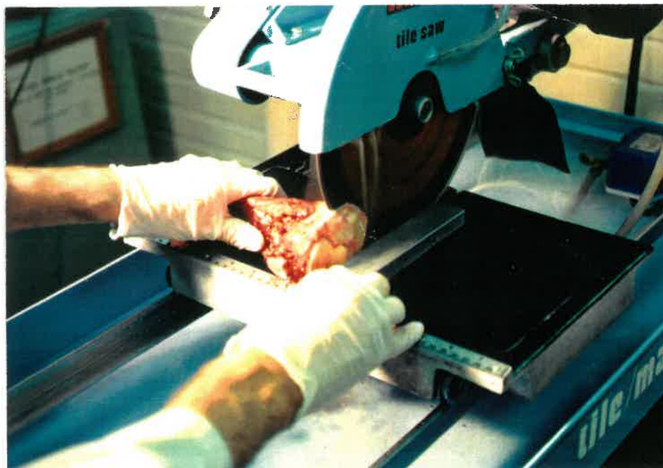
FIGURE 5.4 Première coupe transverse du tibia sur la scie à diamant.
