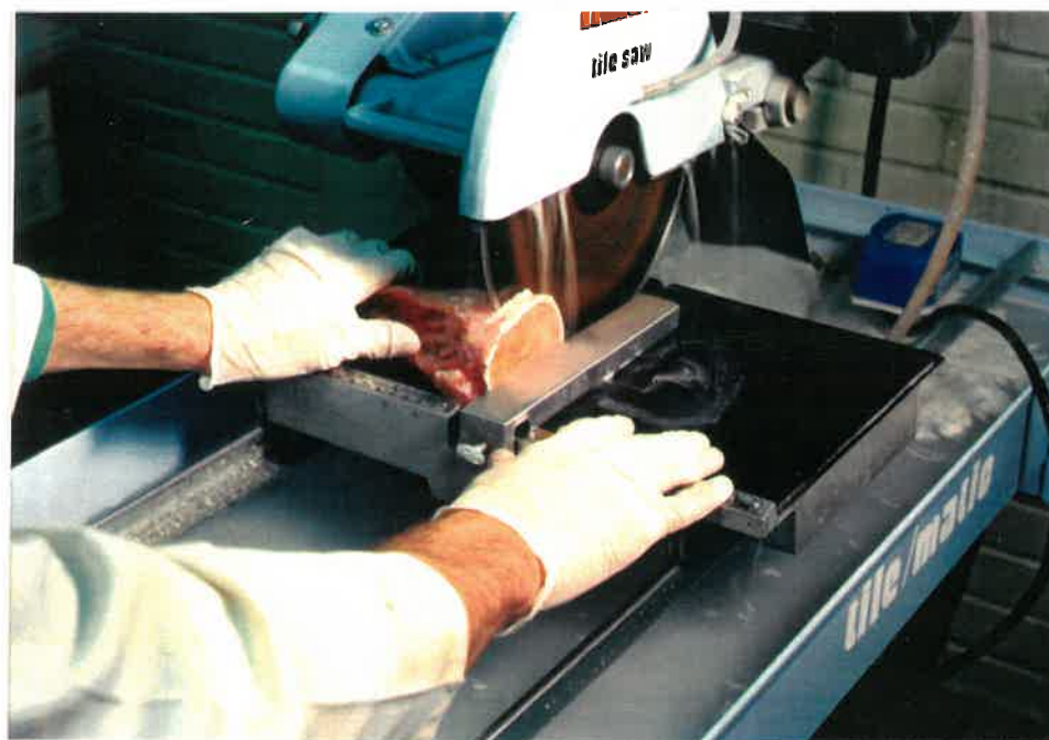
FIGURE 5.4 Première coupe transverse du tibia sur la scie à diamant.
