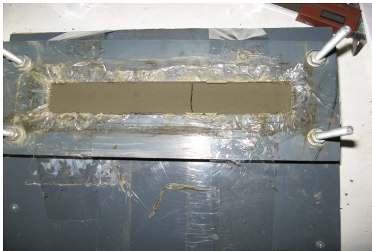
Figure 4.25 Fissure sur l'échantillon du résidu Bulyanhulu durant l'essai de dessiccation non libre
