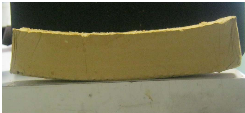
Figure 5.12 Échantillon Manitou 1 soumis au retrait contraint, mais n'ayant pas fissuré (le grillage attaché à la base de l'échantillon s'est déformé).
