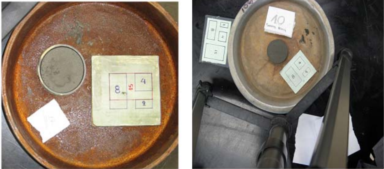
Figure 3.9 Exemples de photographies des échantillons de sol et des échelles utilisées pour déterminer l'aire de l'éprouvette lors de l'essai en cellule de pression
