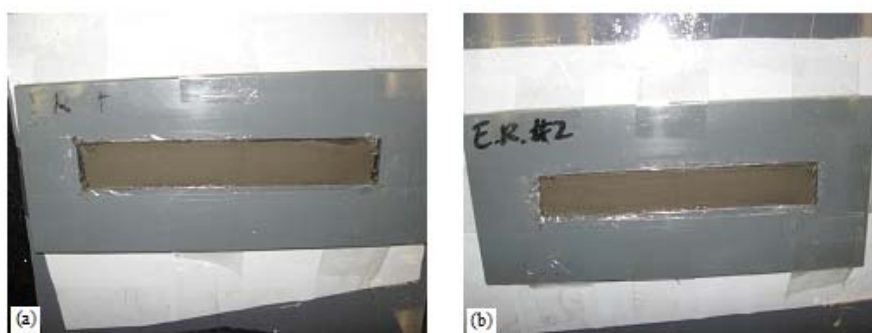
Figure 5.2 État des échantillons en assèchement montrant un retrait en longueur; la déformation n'est pas visible dans le sens de la largeur (résidus Bulyanhulu)
