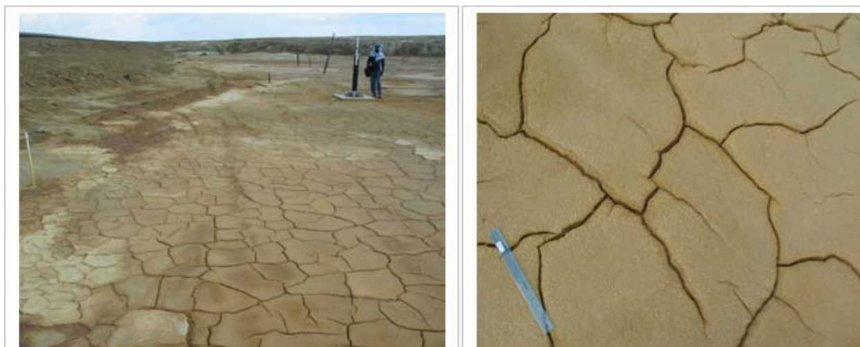
Figure 2.7 Fissures de dessiccation sur le parc à résidus Manitou (Juin 2009).
