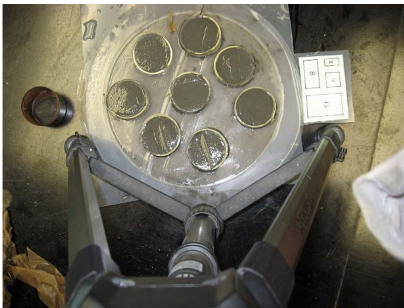
Figure 3.8 Échantillons de sol placés sur la membrane poreuse saturée
