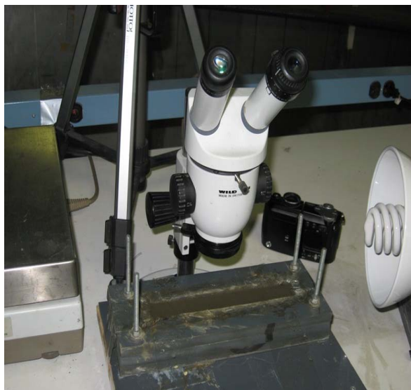
Figure 3.5. Caractérisation de l'apparition de fissure par le stéréoscope grossissant
