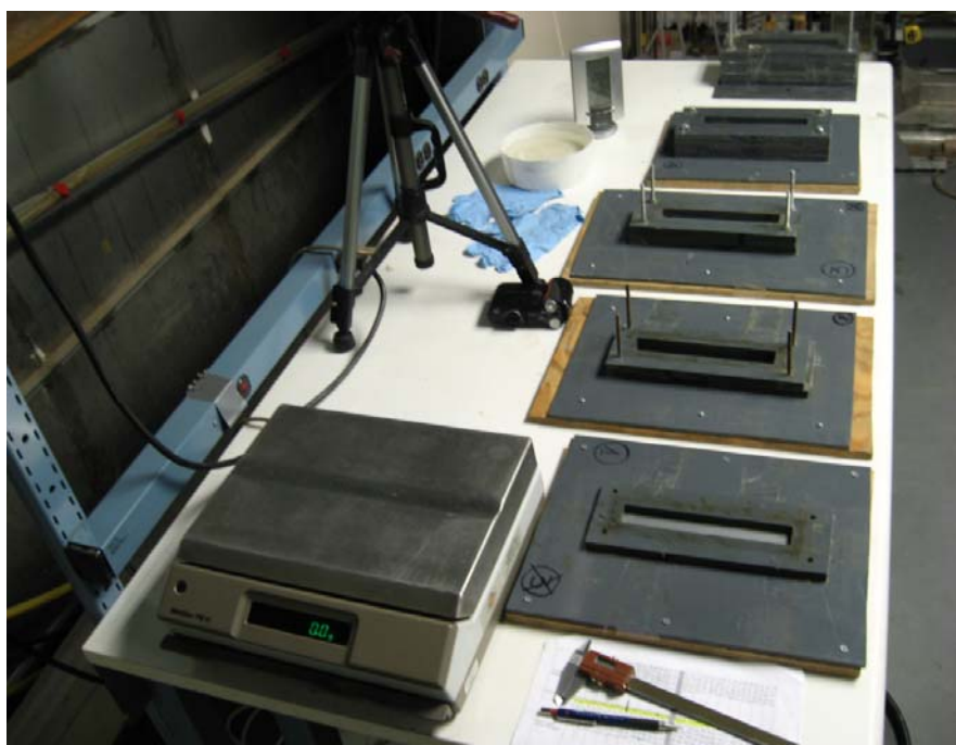
Figure 3.3 Illustration de l'équipement de retrait avec 5 moules d'épaisseurs différentes
