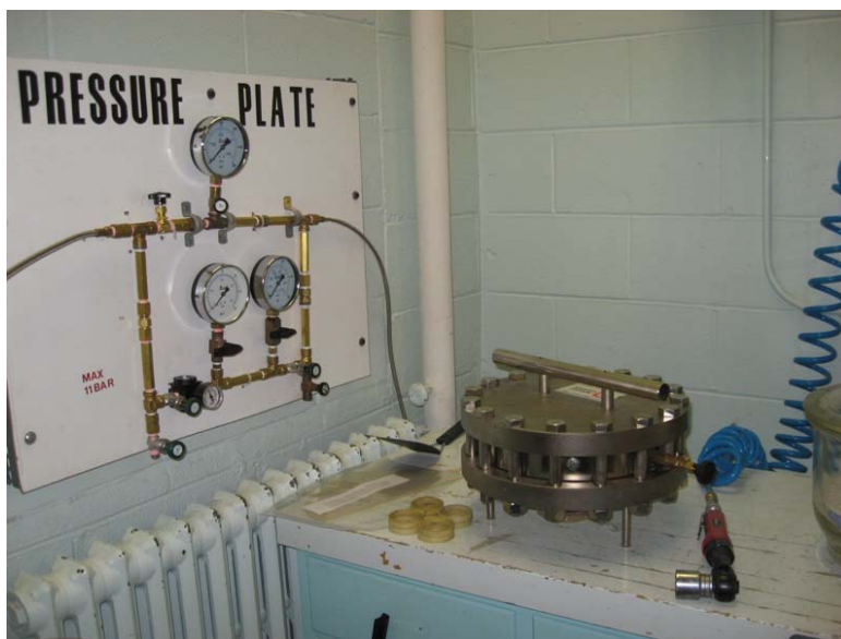
Figure 3.7 Photographie illustrant la cellule de pression avec le circuit pneumatique
