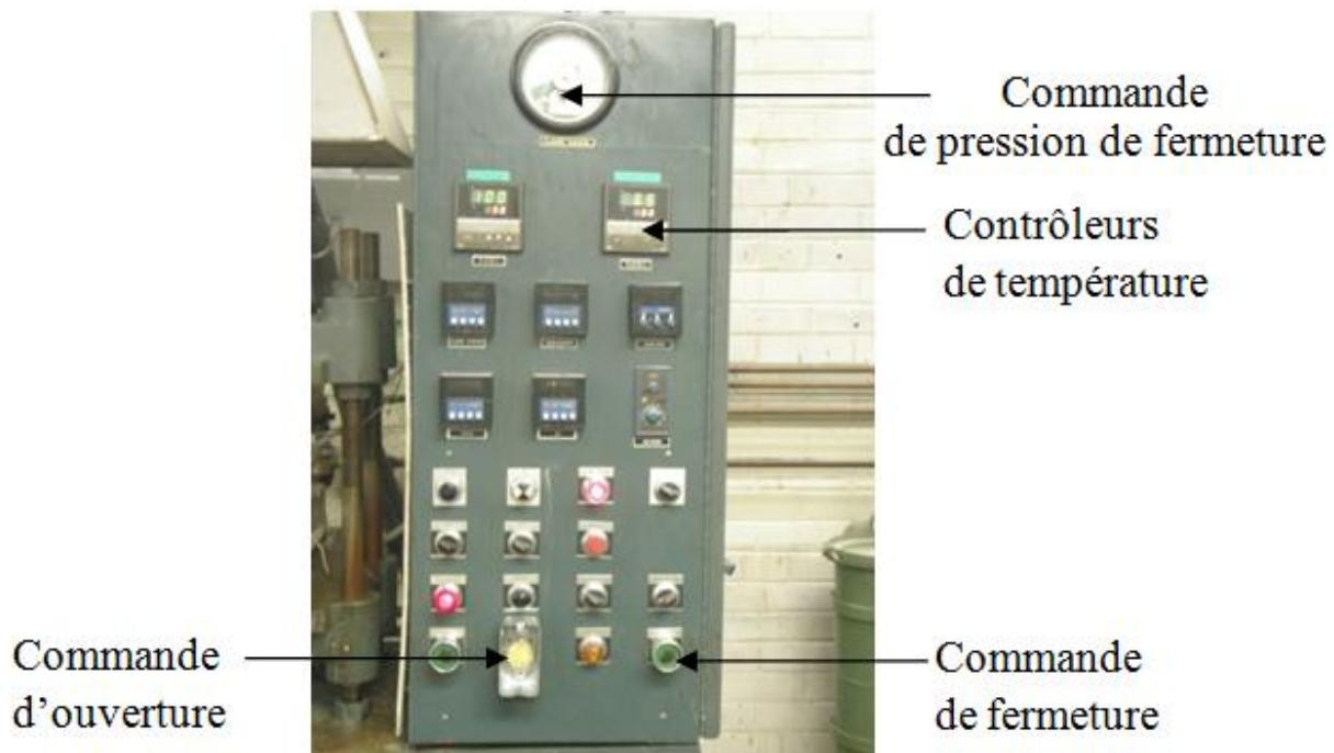
**Figure 5-3 : panneau de contrôle (c).**
