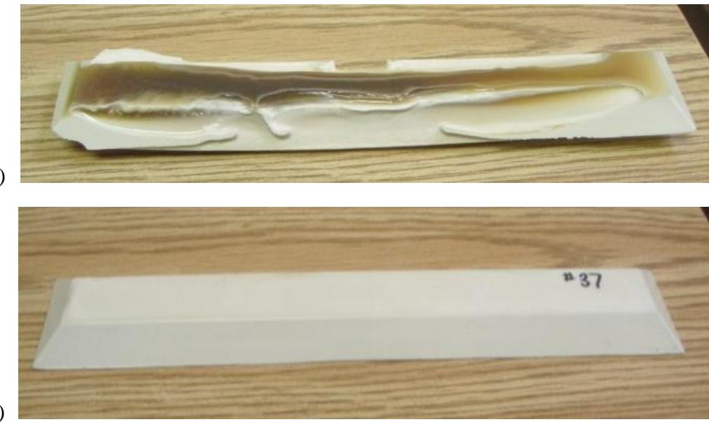
**Figure 4-2 : pièce fabriquée avec des microsphères 3M : a) avec 11% de K20; b) avec 24% de k20.**
