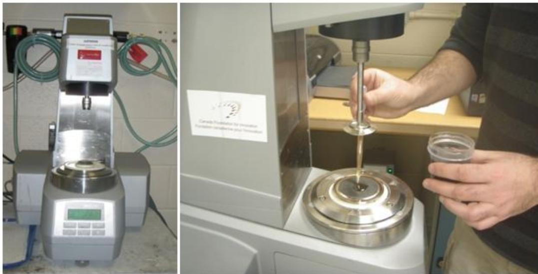
Figure 4-6 : rhéomètre MCR 501 d'ANTON Paar.
