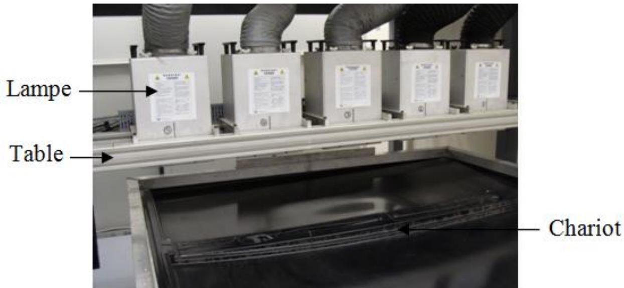
Figure 3-3 : système de cuisson par rayonnement ultraviolet (LFIC).
