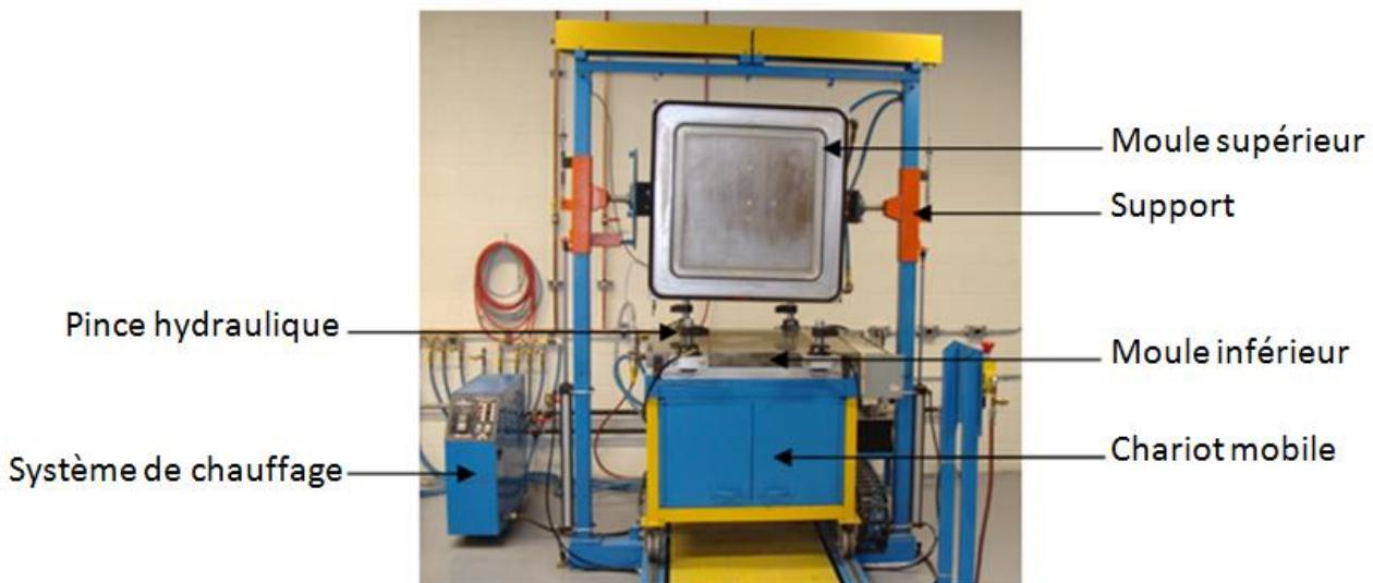
Figure 6-1: système d'ouverture et de fermeture du moule avant modification.
