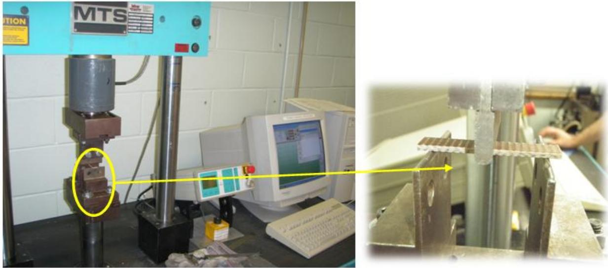
Figure 3-16 : montage d'un test de flexion 3 points sur l'appareil MTS.
