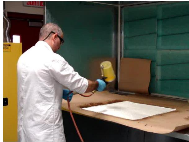
**Figure 3-9 : application de l'adhésif par pulvérisation sur les renforts.**
