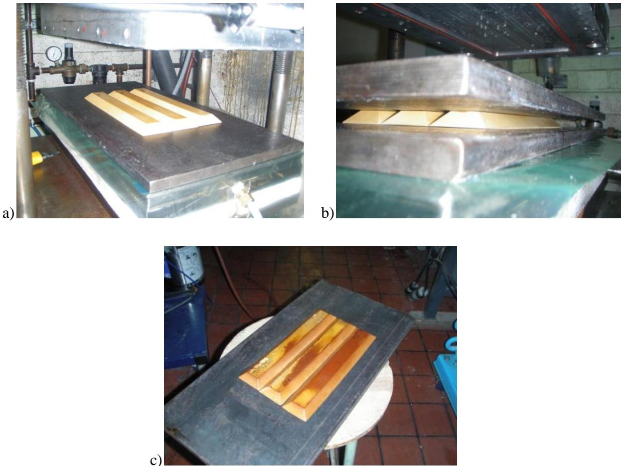
**Figure 4-21 : cycle du test de fluage à 8.3 Bar, 180°C pendant 3 heures.**
