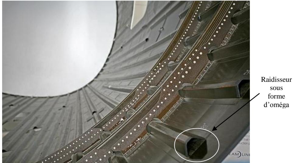
Figure 2-3 : fuselage du Boeing 787.[7]
