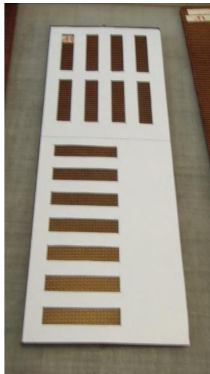
**Figure 3-15 : disposition des échantillons selon deux directions.**
