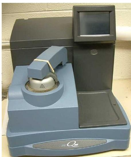
**Figure 4-3 : appareil de calorimétrie différentielle DSC, Q1000 TA Instrument.**
