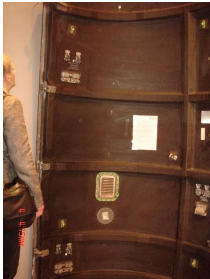
Figure 7-4 : photos d'une partie d'un fuselage d'avion renforcé par des nervures oméga (JEC 2010).
