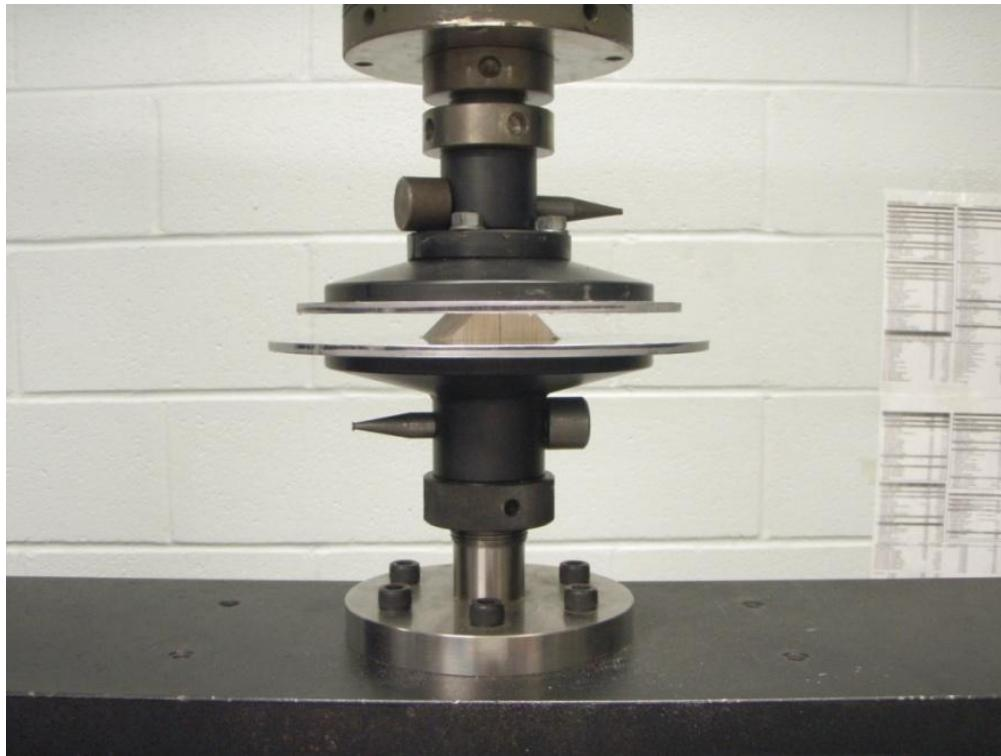
**Figure 4-13 : montage du test de compression.**
