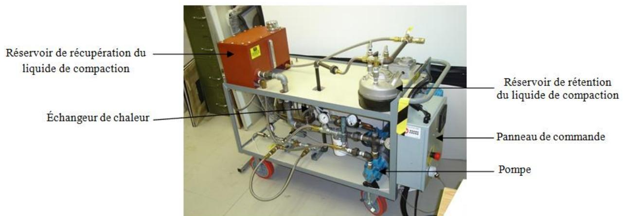
Figure 5-4 : système de compaction.
