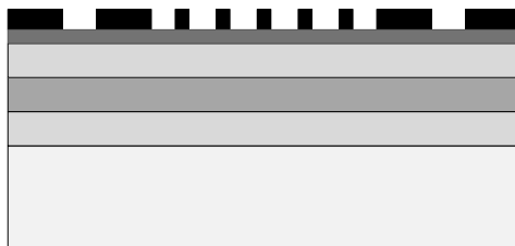
d) Lithographie par faisceau d'électrons des cristaux photoniques et des actionneurs et développement
