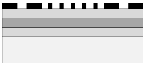
c) Lithographie par faisceau d'électrons des cristaux photoniques et des actionneurs et développement
