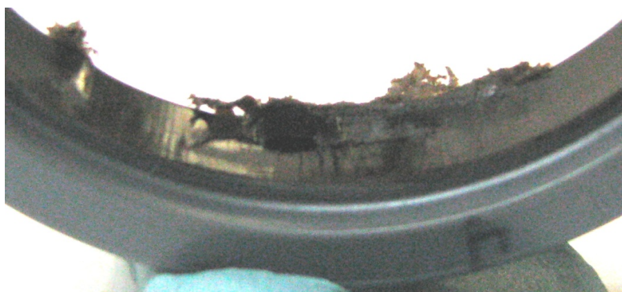
Figure 4.51 : Joint d'étanchéité de Hallite ayant subi une usure majeure lors de la sélection des joints d'étanchéité V1
