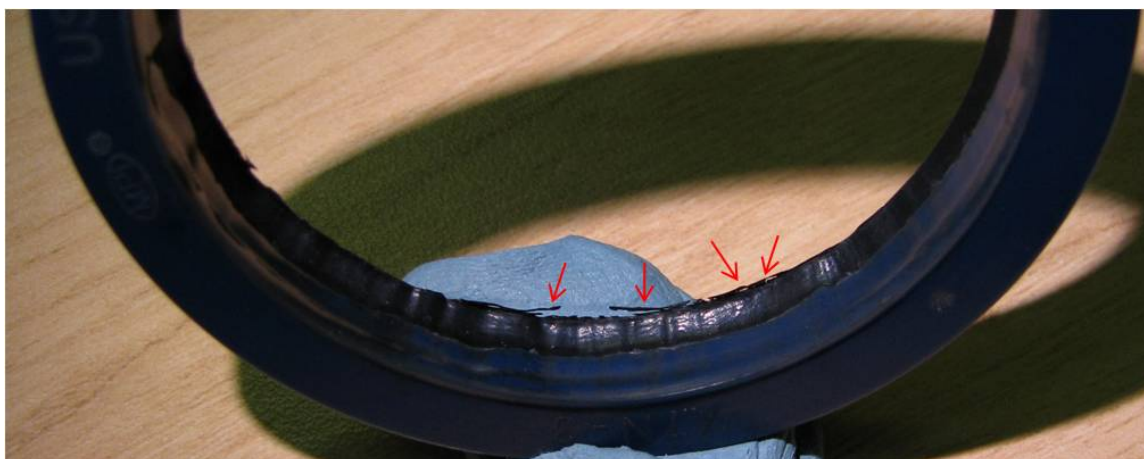
Figure 4.49 : Joint d'étanchéité de SKF Polyseal ayant subi une usure majeure lors de la sélection des joints d'étanchéité V1
