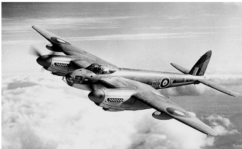
Figure 2.3 L'avion militaire Britannique; Le Mosquito, en structure sandwich [6].
