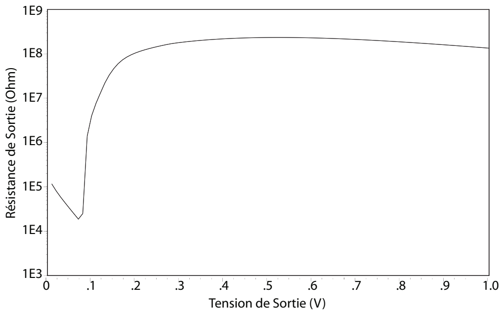
FIGURE 3.11 Résistance de sortie du miroir de courant proposé pour un courant d'entrée de 10 \mu A .
