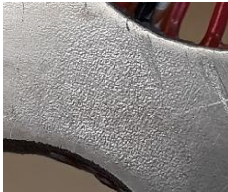
Figure 7.1 État de surface après 10 millions de cycles
