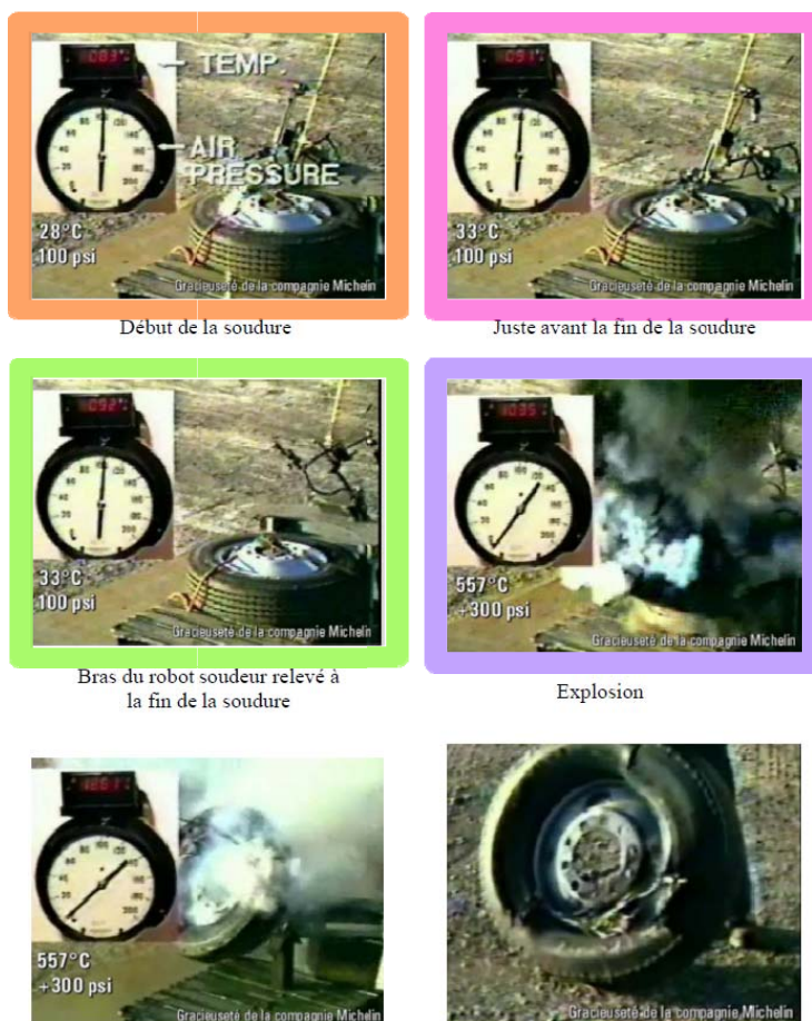
Figure 2-6 Essai d'explosion par soudure sur la jante
