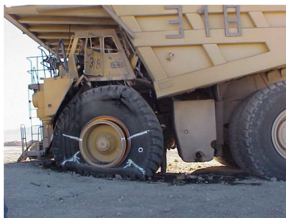
Figure 2-1 Explosion de pneu survenue à la mine Radomiro au Chili en 2000
