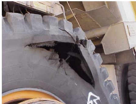
Figure 4-13 Rupture du pneu lors de l'accident survenu à la mine Radomiro Tomic
