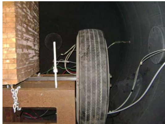
Figure 4-21 Le pneu, dans sa position verticale, est fixé à un support
