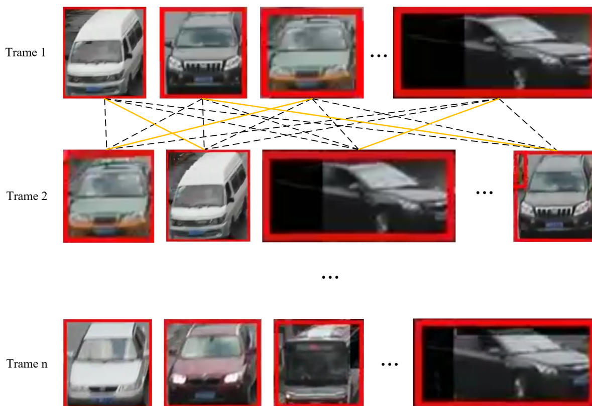
Figure 2.2 Illustration du problème d'association des données. Les objets peuvent sortir et entrer dans la scène d'où le fait que les objets de la trame n ne correspondent pas tous à ceux des deux premières trames.
