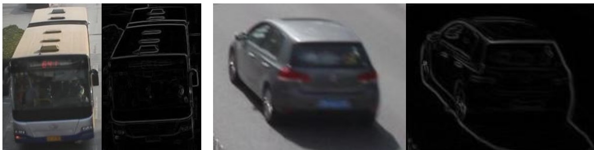
Figure 2.1 Exemples de détections (images de gauche) et d’une représentation de leurs gradients (images de droite)
