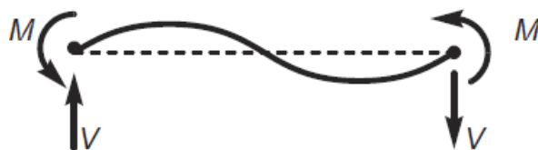
Figure 2.24 : Flexion d'un contreventement en courbure double
