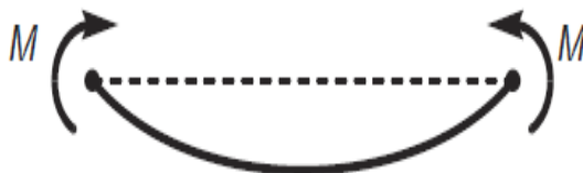
Figure 2.23 : Flexion d'un contreventement en courbure simple
