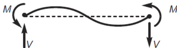
Figure 2.24 : Flexion d'un contreventement en courbure double
