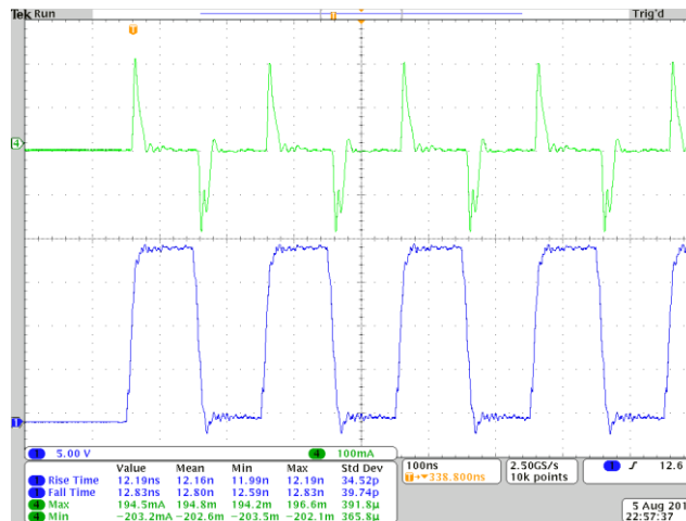
Figure 3.14 : Capture d'oscilloscope d'une sortie à haute tension. Le courant entrant dans la charge est montré en vert, la tension en bleu.
