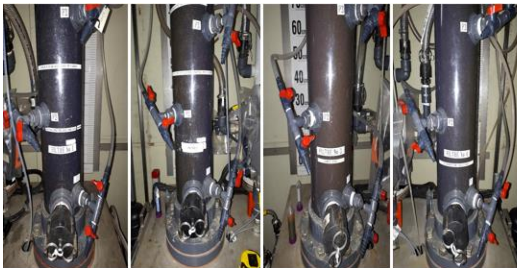
Figure 3.7 Configuration des filtres pilotes de gauche à droite : sable/anthracite, MonoMulti Filtralite®, Sable et Filtralite® NC.
